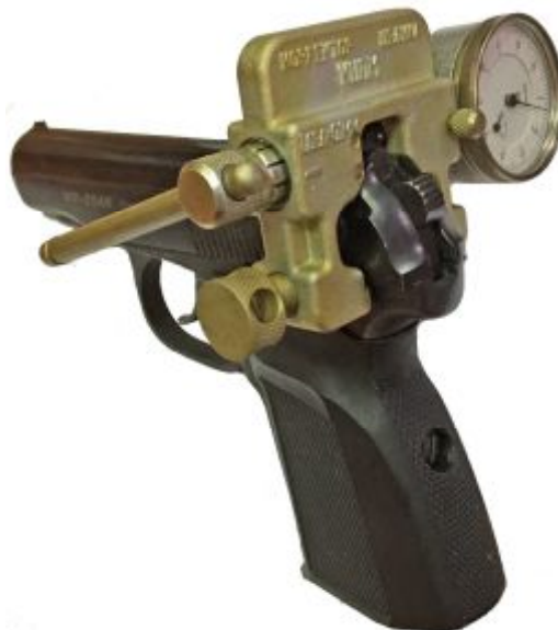
Рисунок 8 – Установка КЦПМ на пистолет ПМ для смещения целика вправо
