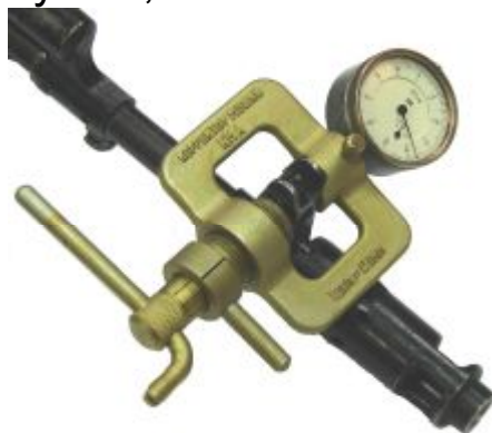
Рисунок 7 – Установка КМА для смещения ползка мушки влево
