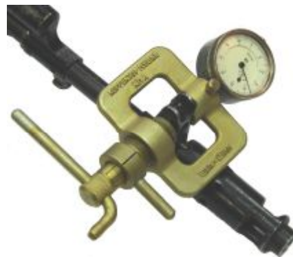
Рисунок 7 – Установка КМА для смещения ползка мушки влево
