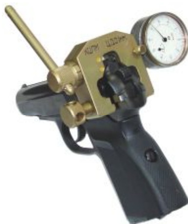
Рисунок 8 – Установка КЦПМ на пистолет ПМ для смещения целика вправо
