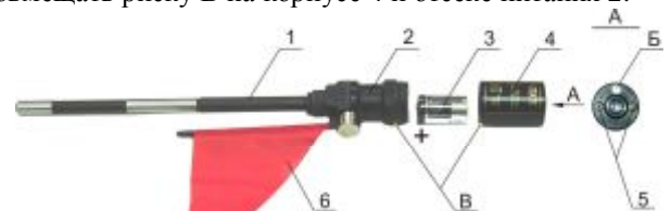
1 – калибр; 2 - отсек питания; 3 – элемент питания CR2; 4 – корпус; 5 – винты регулировочные; 6 – флажок; Б – метка; В - риски
