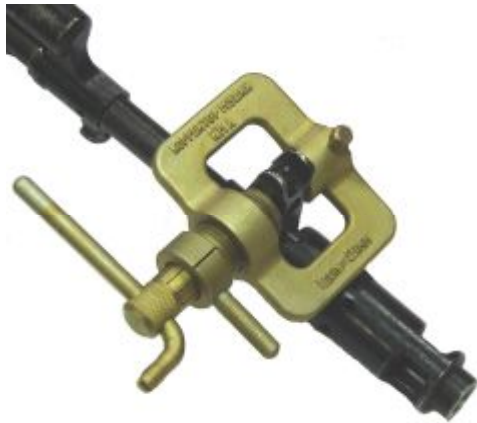
Рисунок 2 – Установка корректора мушки КМА для смещения ползка мушки влево
