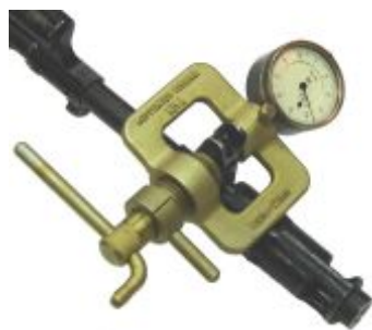
Рисунок 2 – Установка корректора мушки КМА-И для смещения ползетка мушки влево
