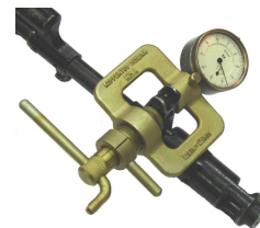
Рисунок 2 – Установка КМА для смещения ползка мушки влево
