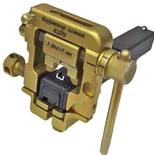
Рисунок 2 - Установка затвора пистолета в КЦПУ
