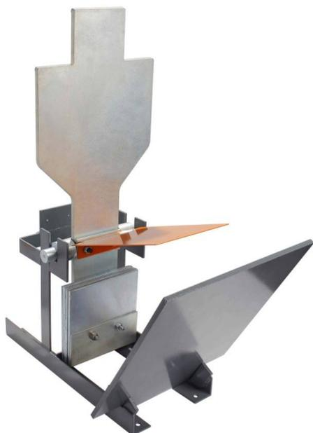
Мишень «Неваляшка» предназначена для звукового и визуального подтверждения попадания пули при проведении учебных и зачетных стрельб из стрелкового оружия за счет усиления звука удара пули и подъема сигнального флажка при опрокидывании языка мишени. Мишень возвращается в исходное положение автоматически.
